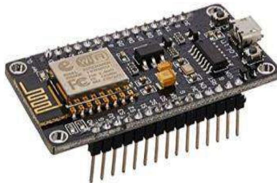
Figure : Wi-Fi module
